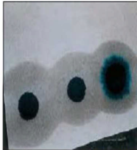
Auréole bleue apparaissant à la de la tache indiquant la fin de l'adsorption du bleu sur le sol.
