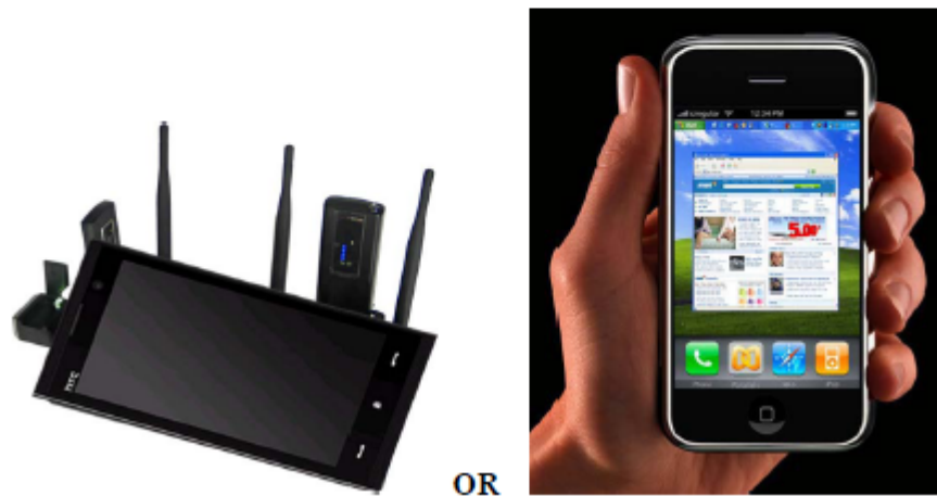
FIG. 1.9 – 4G Téléphone avec des antennes classiques impossible a utilise. iPhone 4G téléphone avec une antenne imprime [8].
