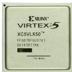
FIGURE 5.1 – Exemple d’un circuit FPGA de type Virtex-5 de la famille Xilinx
