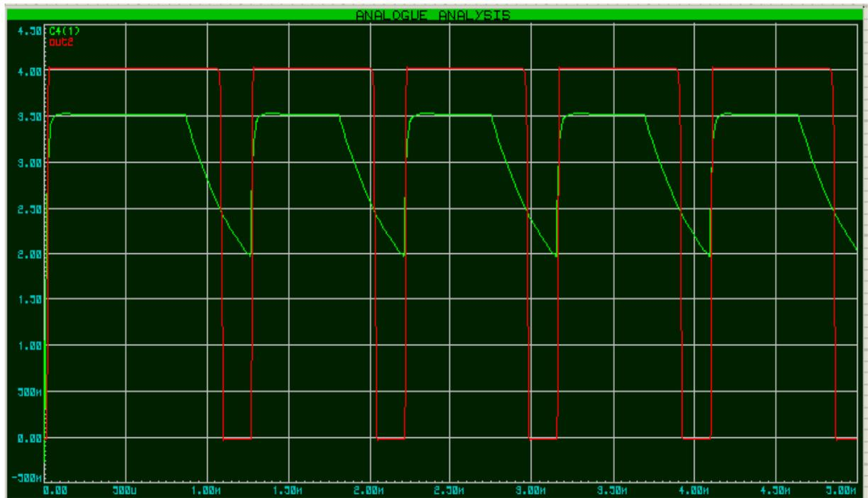
Fig. IV.13 L'allure de la sortie du comparateur U3 aux passages des essieux
