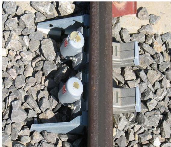
Fig. I.7 Double contact de rail « sk1 », « sk2 »
