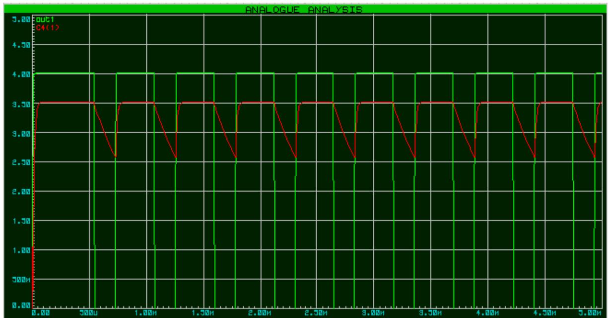
Fig. IV.11 Charge et décharge du condensateur C4
