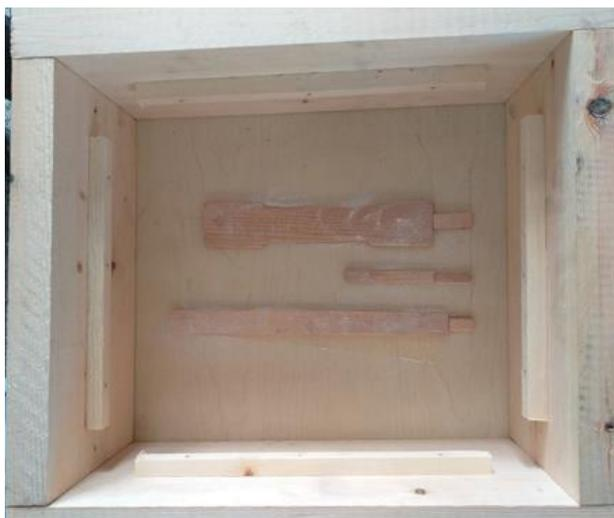
*Figure 13: Remplissage du châssis avec le sable.*
