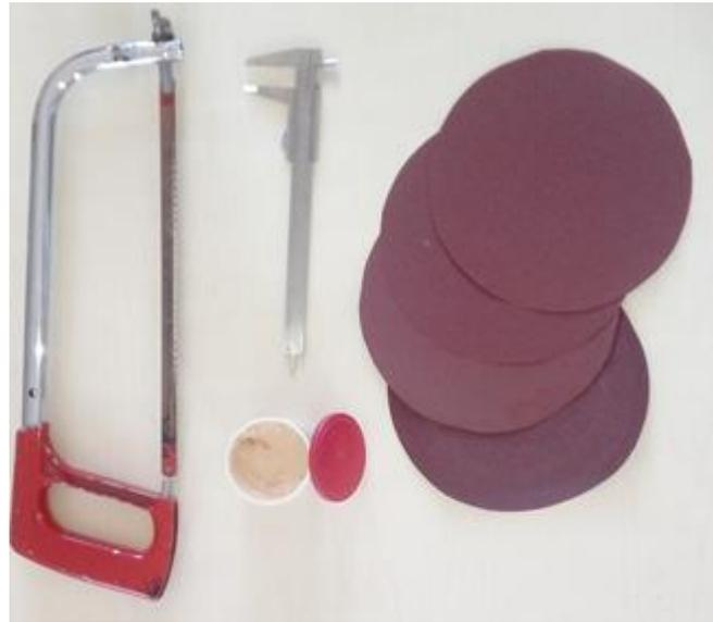
Figure 11: Matériels utilisés pour le modelage.
