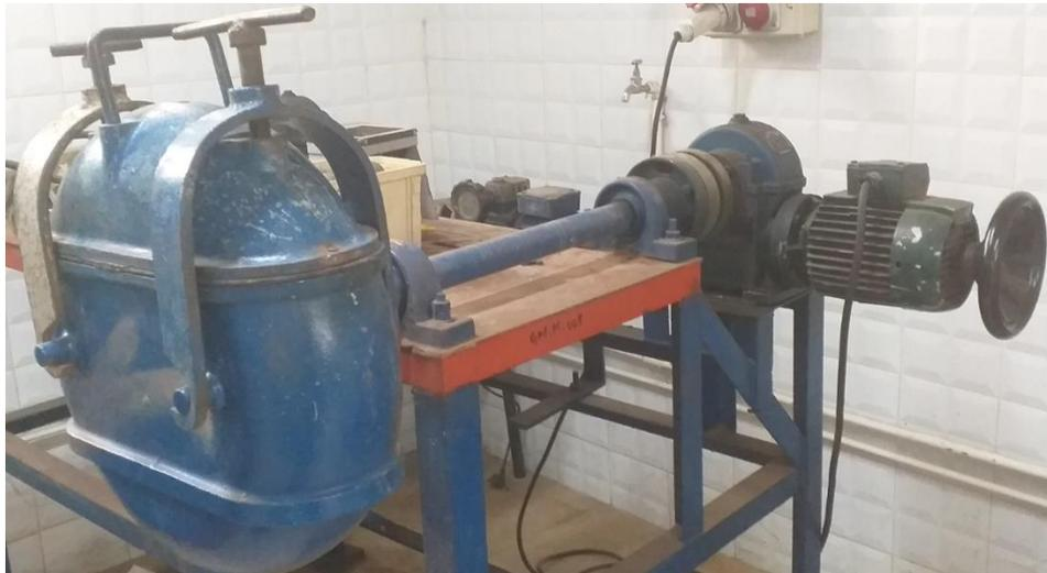
*Figure 9: Broyeur à boulets.*
