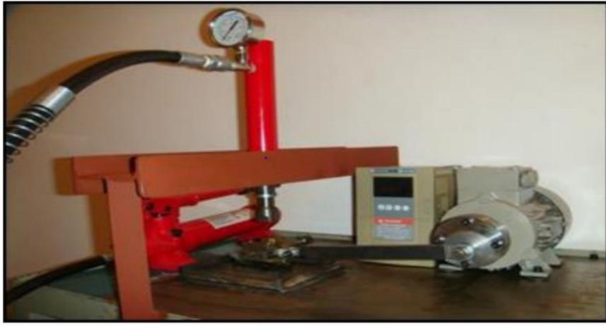
*Figure 29: Tribomètre bille-plan [33].*
