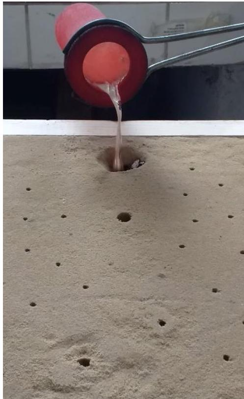
*Figure 16: Coulée et remplissage du moule.*
