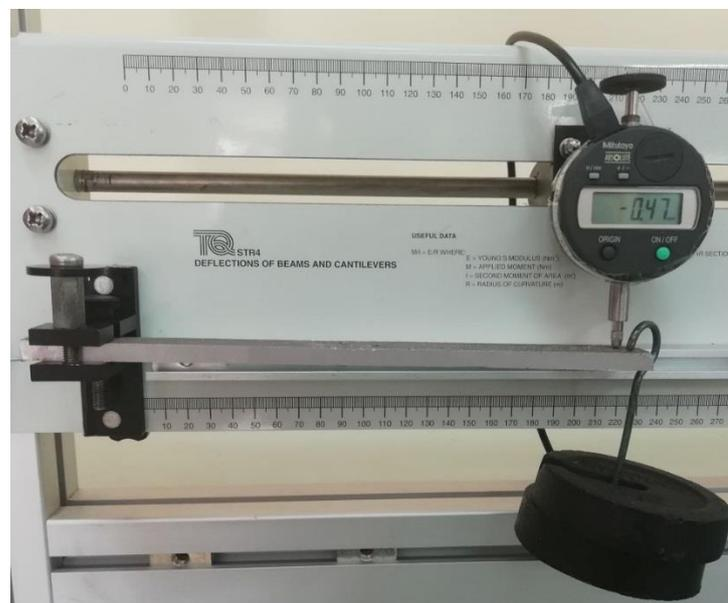
Figure 27: Eprouvette testée sur l'équipement d'essai de flexion STR4.
