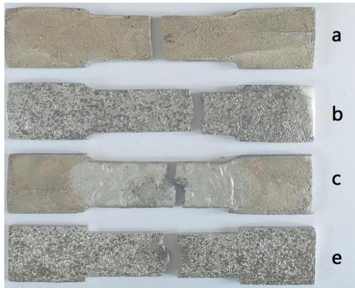
Figure 41: Éprouvettes de traction après rupture a-A-U4G brute de coulée ; b- A-U4G avec une face en céramique grossière ; c-mélange : A-U4G /céramique fine en volume et en surface ; e-mélange : A-U4G /céramique grossière en volume et en surface.
