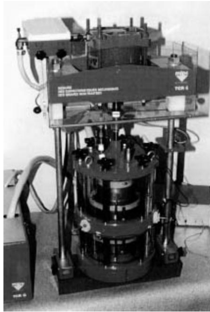
Fig.III.6.1.1 : Cellule de l'appareil TCR.
