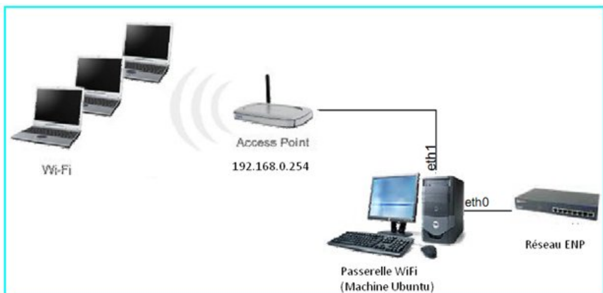
Figure 4.1 – Schéma de l'architecture avec un seul point d'accès
