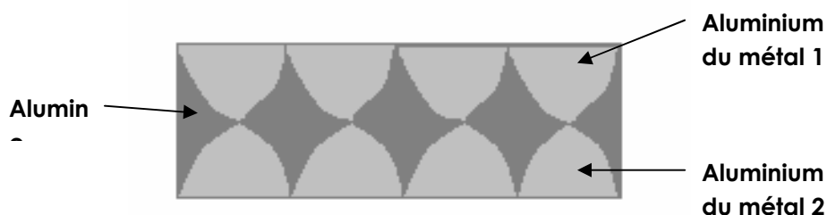
Figure 3.7 : Etat de l'interface métal1-métal2 après recuit de guérison
