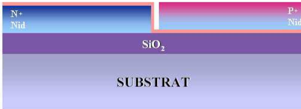
Figure 2.26 : Structure après définition des îlots P
