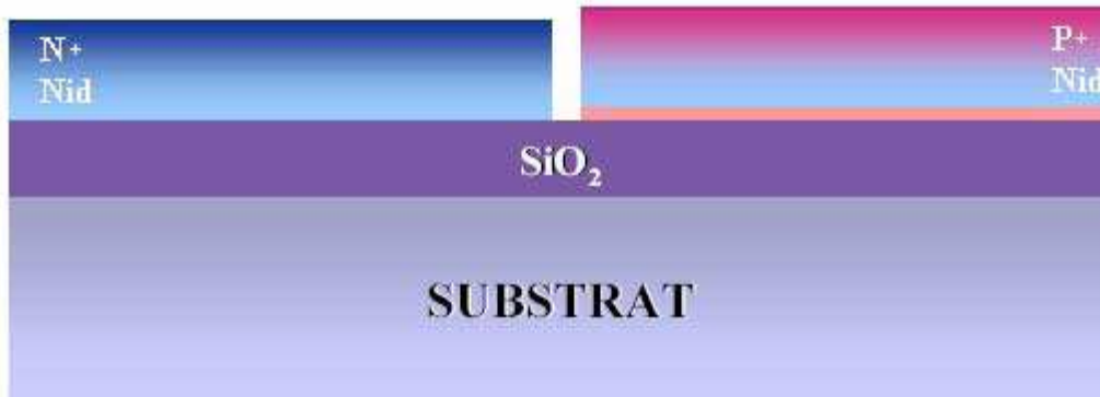
Figure 2.27 : Structure obtenue après gravure de l'oxyde de protection APCVD
