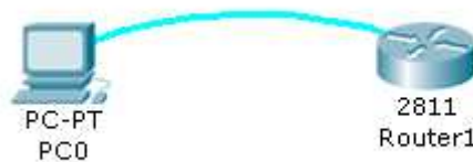
Figure IV-2 : Accès au routeur par câble console
