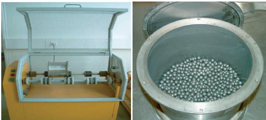
Figure 5.8. Appareil MDE et tambour avec billes en acier
