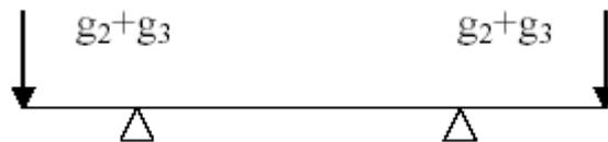
$$g_2 = \text{poids de la corniche et du garde corps} = 1 + 2.75 = 3.75 \text{ KN}$$
