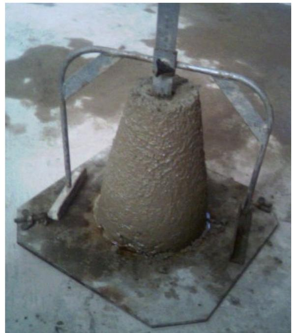
**Figure 4:** Affaissement de cône d'abrams
