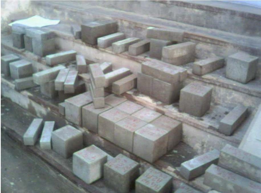
Figure5: Eprouvettes après démoulage .
