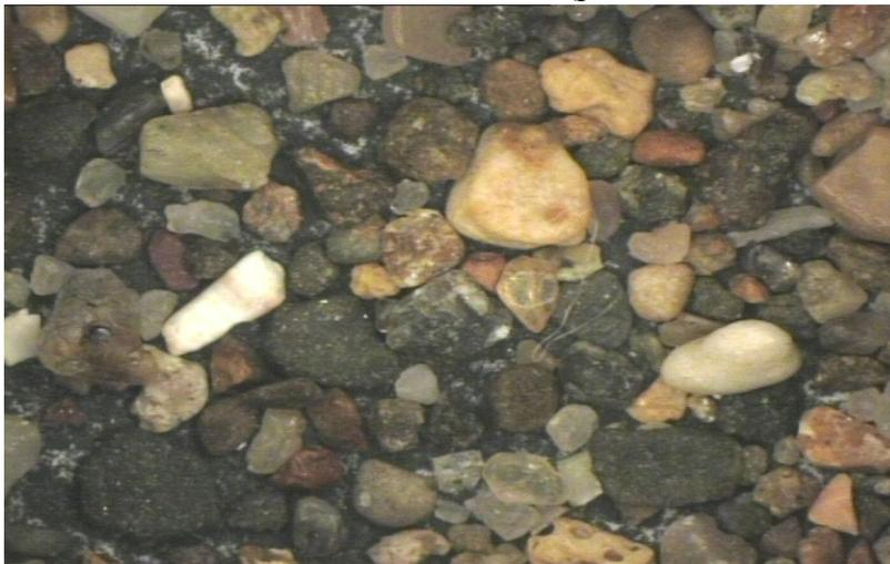
**Fig 3.2:** Vue du sable naturel (SN) prise avec le vidéo microscope (×50)
