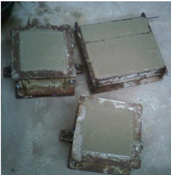
**Figure 3:** Eprouvettes du béton avant démoulage.
