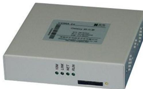
Figure 7- Les LED sur le routeur.
