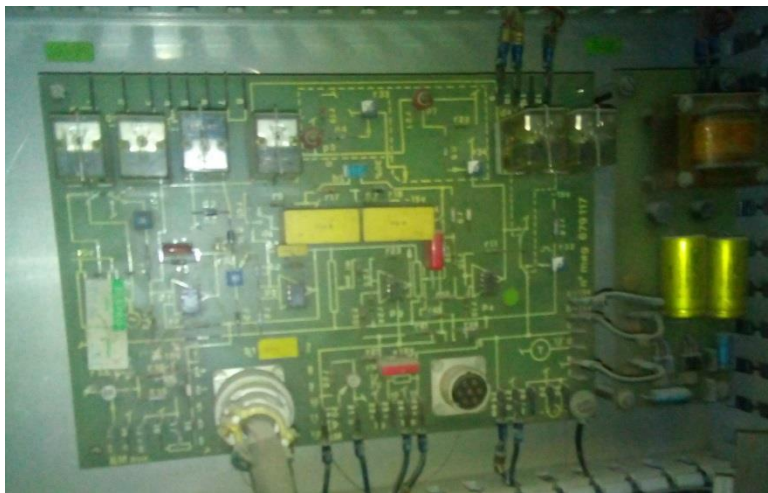
Figure 1-16 : la carte électronique des vitesses
