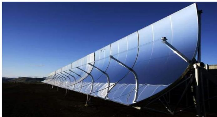
**Figure 1.1** : Collecteur cylindro-parabolique.
