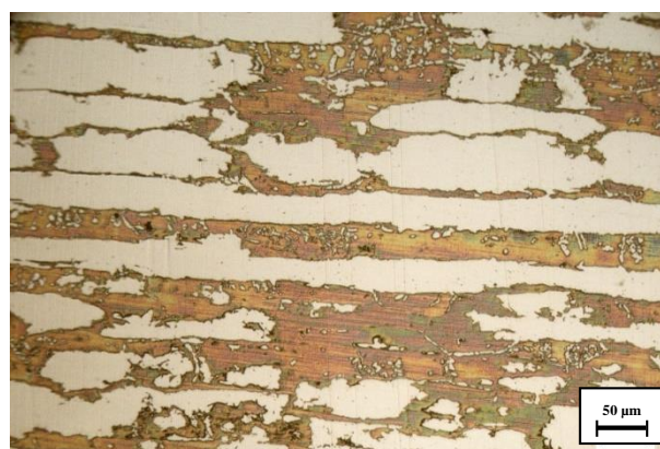
Figure 4.8 Micrographie optique du métal de base après 2500 cycles.
