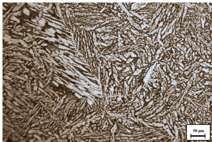
Figure 4.18 Micrographie optique de la Zone Fondue après 2500 cycles.
