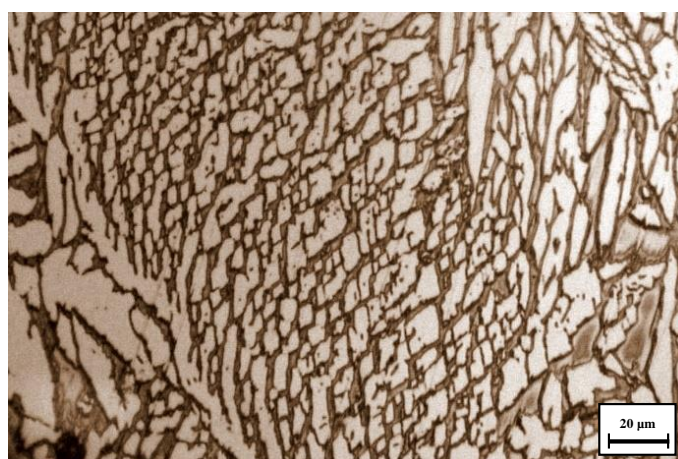
Figure 4.19 Micrographie optique de la Zone Fondue après 2000 cycles.
