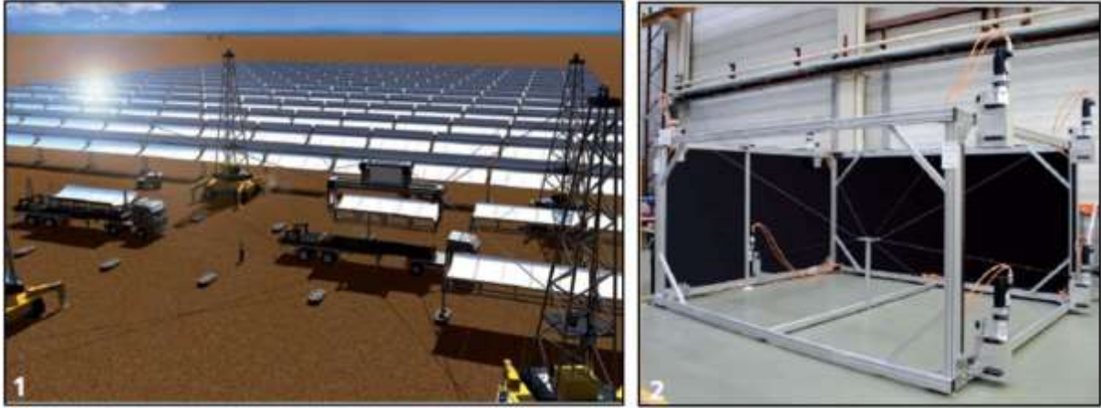
Figure (I-4) : IPAnema, mécanisme parallèle à 6ddl entraîné par des câbles [7].
