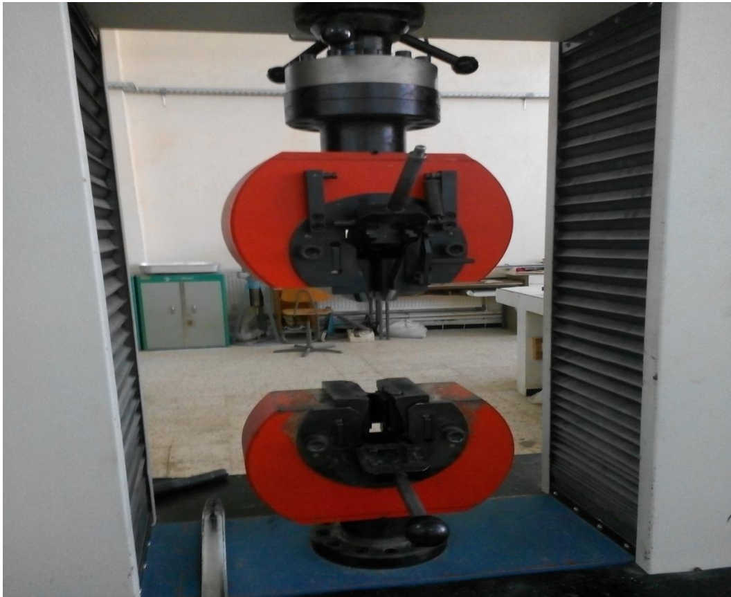
Figure II.4 : machine de traction utilisée pour l'exécution de nos essais.
