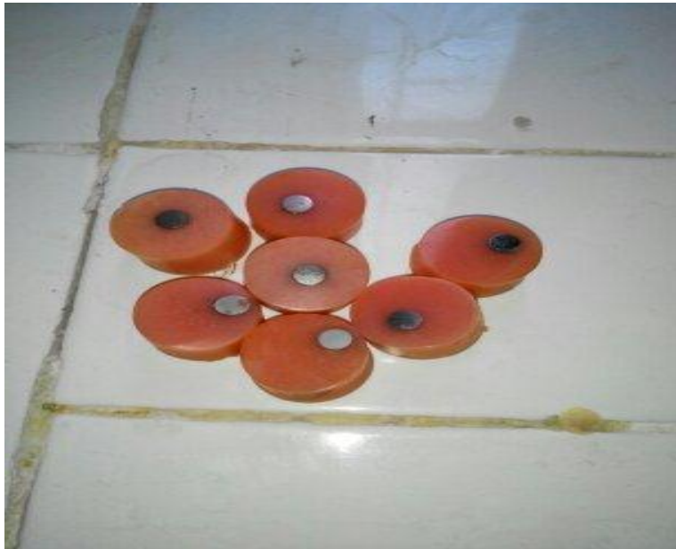
Figure II.17 : photo des échantillons après l'enrobage.
