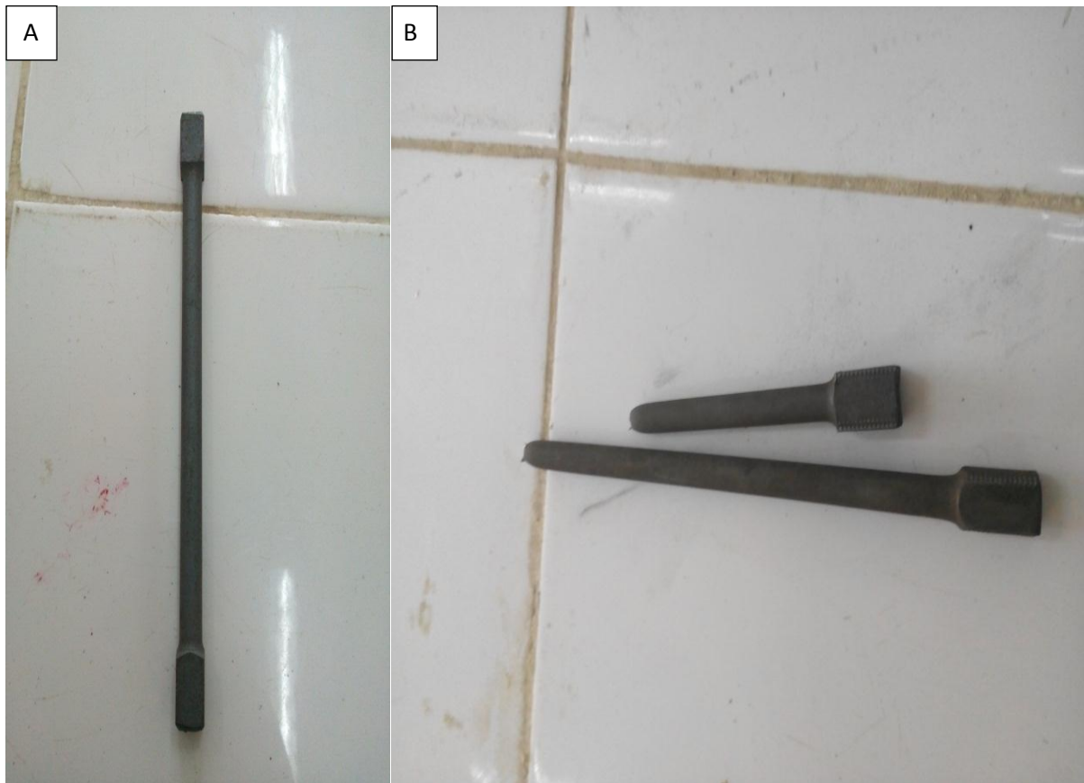
Figure II.7 : éprouvette de traction :A) avant essai B) après essai.
