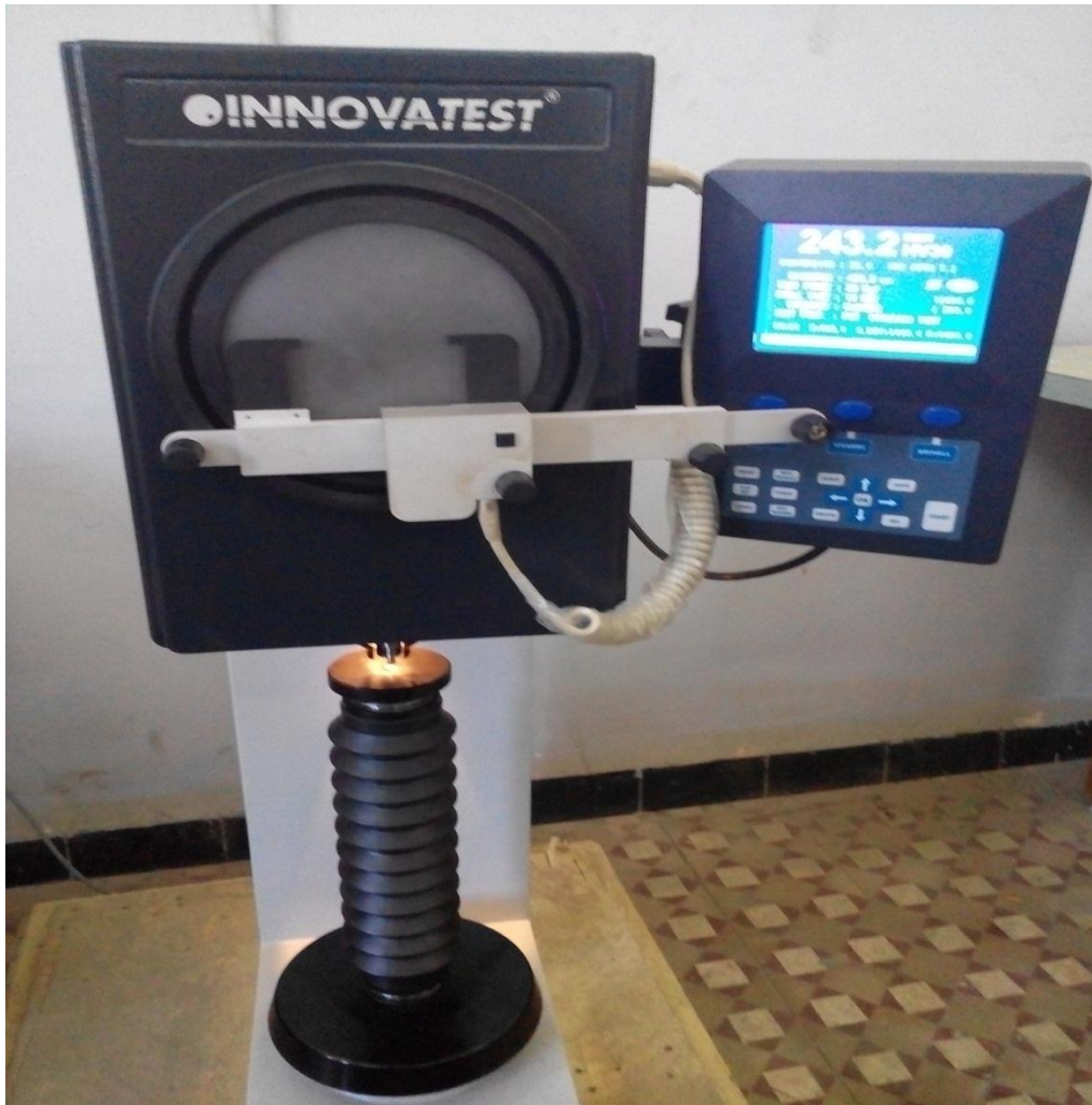
Figure II.16 : Duromètre utiliser pour l'essai de dureté Vickers.
