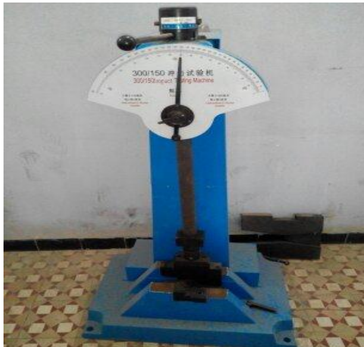
Figure II.12 : mouton Charpy utilisé pour l'exécution de nos essais de résilience.
