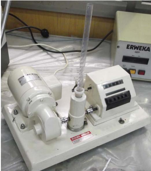
**Figure III.16 :** Appareil de mesure de la densité tassée
