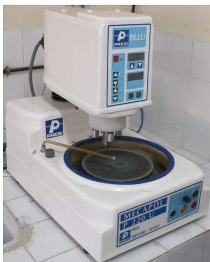
**Figure III.15** : Polisseuse de type MECAPOL P 220 U.
