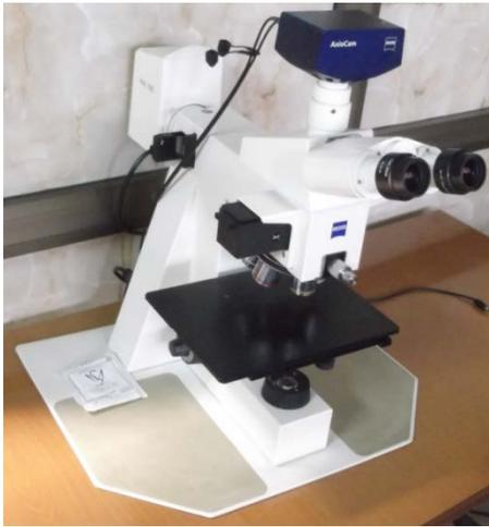
**Figure III.18** : microscope optique de type ZEISS.
