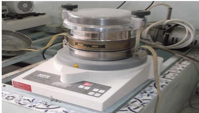
**Figure III.3 :** Secoueuse de type pulverisette 0 – Fritsch contenant deux tamis.
