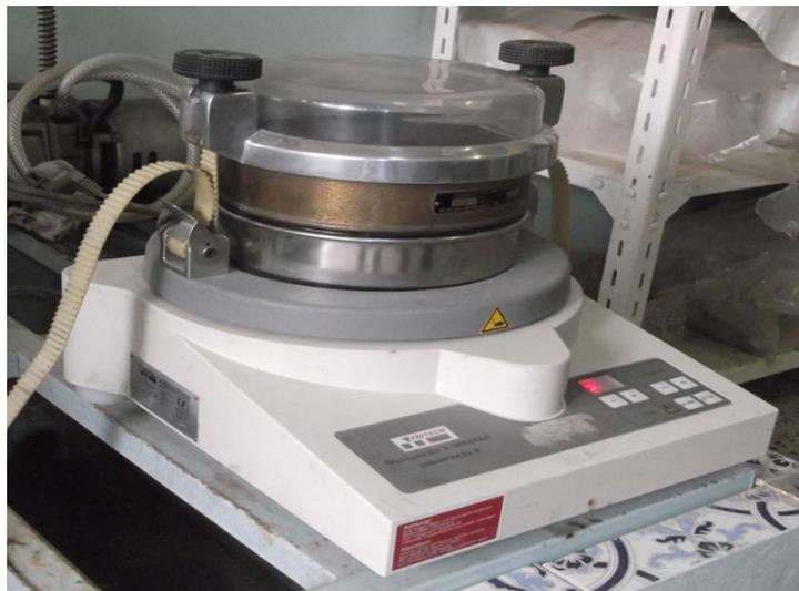
**Figure III.2** : Secoueuse de tamis type pulverisette 0 – Fritsch.
