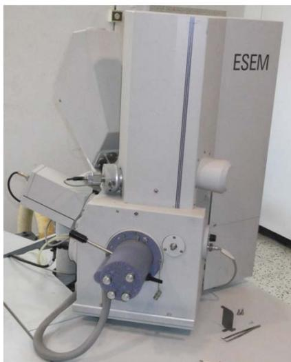
**Figure III.19** : microscope électronique à balayage de type ESEM.
