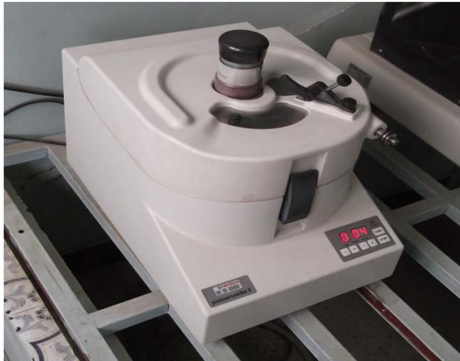
**Figure III.1** : Broyeur à boulets type pulverisette 2 – Fritsch.
