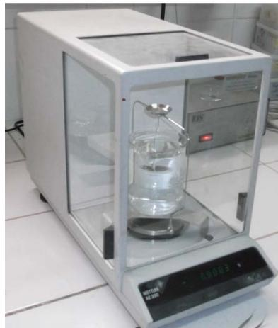
**Figure III.17** : Appareil de densimétrie par immersion.
