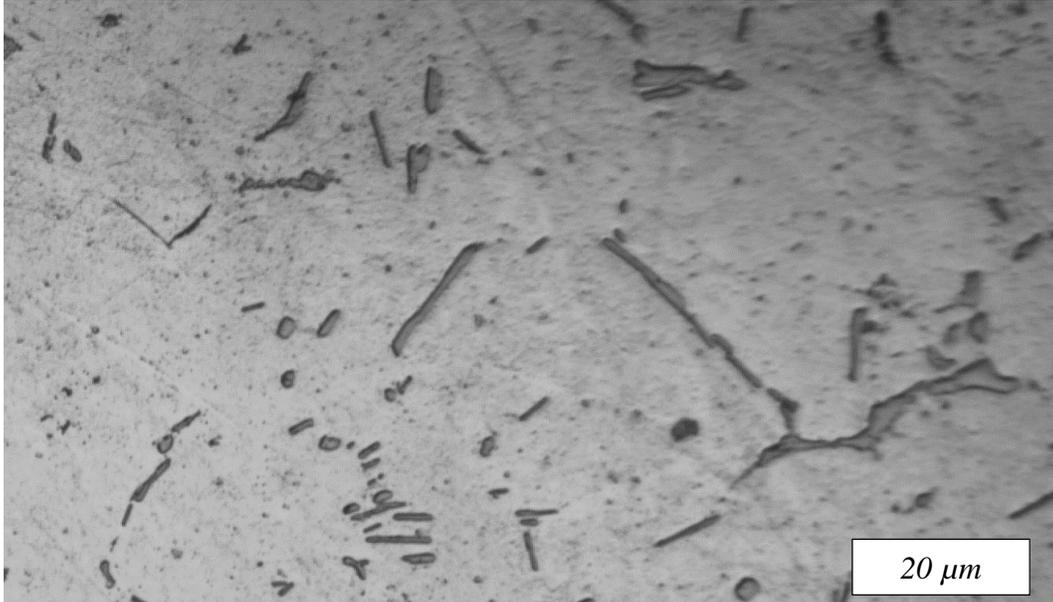
**Figure IV-6 :** Micrographie optique de la surface d'alliage Aluminium 7075 obtenue après 2 h d'immersion dans la solution de NaCl 0,1 M.
