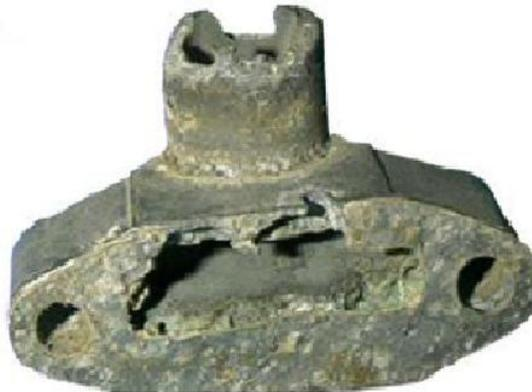
*Figure II-3 : Corrosion générale d'une pièce en alliage d'aluminium [14]*
