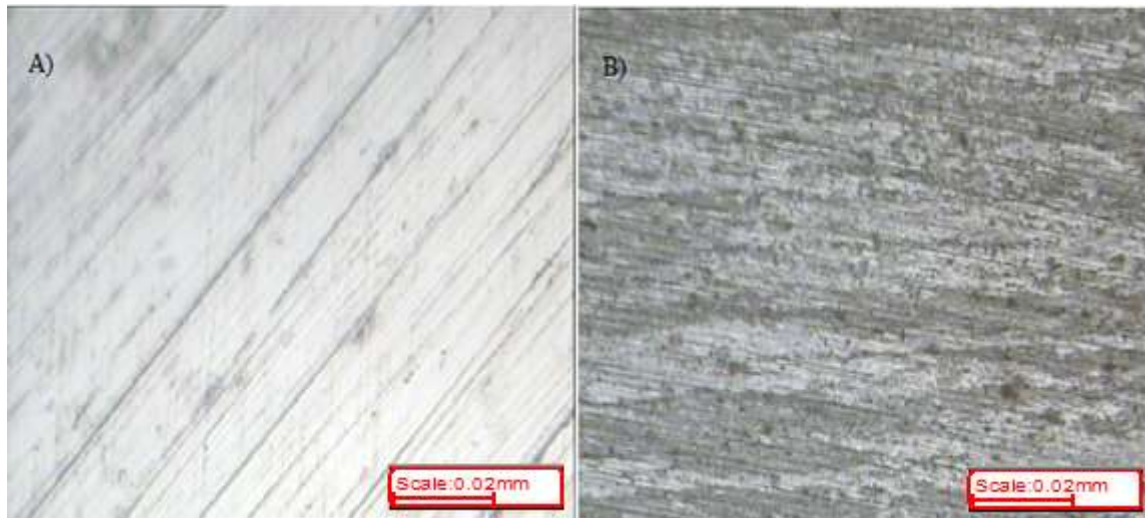
Figure IV.25 : Micrographie de la surface de l'acier homogénéisé après ajout d'inhibiteur, comparé à l'état initial, A) sans inhibiteur, B) avec inhibiteur
