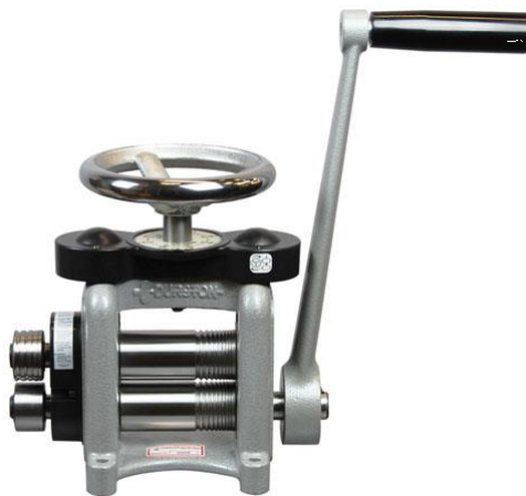
FIGURE V.5 – Laminoir manuel utilisé.
