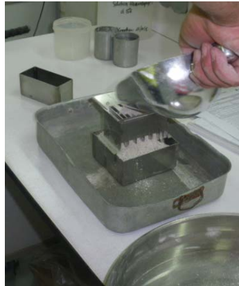
Figure II-11: Echantillonneur de Sables pour essais VB/ES.
