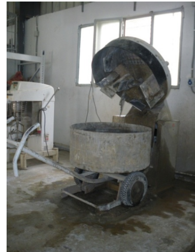
Figure III-3: Malaxeur Utilisé pour le Gachage des Bétons (CDL)
