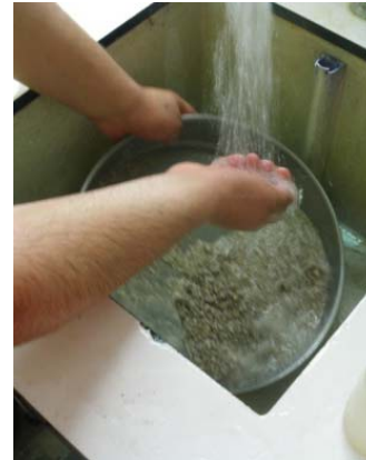
Figure II-12: Lavage des Granulats avant essais.
