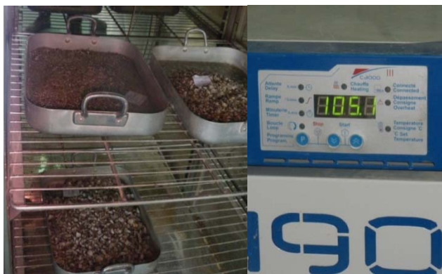
Figure II-13: Etuvage à 105°C pendant 24H
