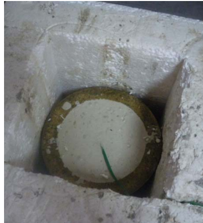
Figure III-11: Mise en place de l'éprouvette avec thermocouple dans un caisson d'isolation.
