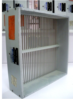
Figure II-17: Grille à fontes pour la détermination de l'aplatissement.
