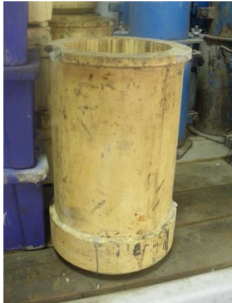
Figure III-10: Moule cylindrique d'éprouvette à béton.
