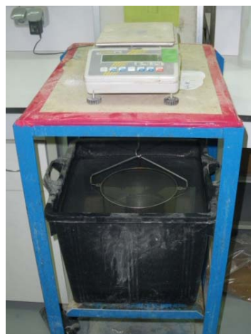
Figure II-23: Panier immerger dans l'eau relié à une balance.
