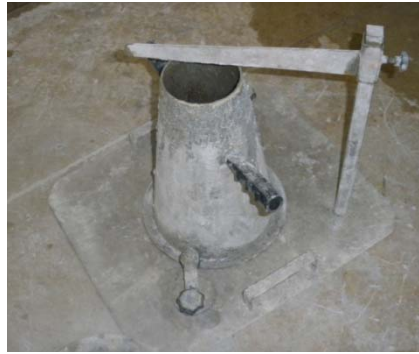
Figure III-4: Cône d'ABRAMS pour Slump-Test.
