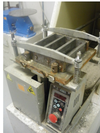
Figure II-3: Moule sur table à choc.
