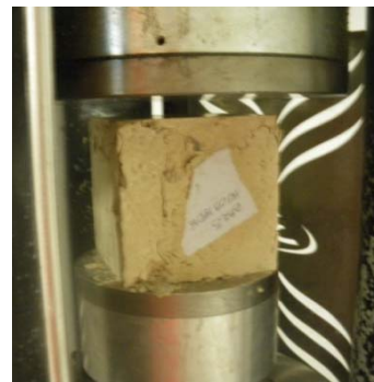
Figure III-6: Ecrasement d'Eprouvette Cubique B52,5.
