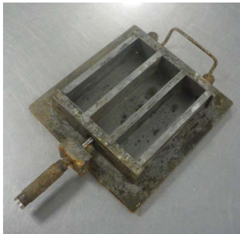
Figure II-2: Moule à éprouvettes Prismatique 40×40×160
