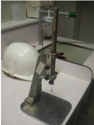
Figure II-7: Appareil de VICAT (CDL).
