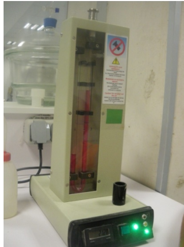
Figure II-9: Appareil de mesure de la SSB (CDL).
