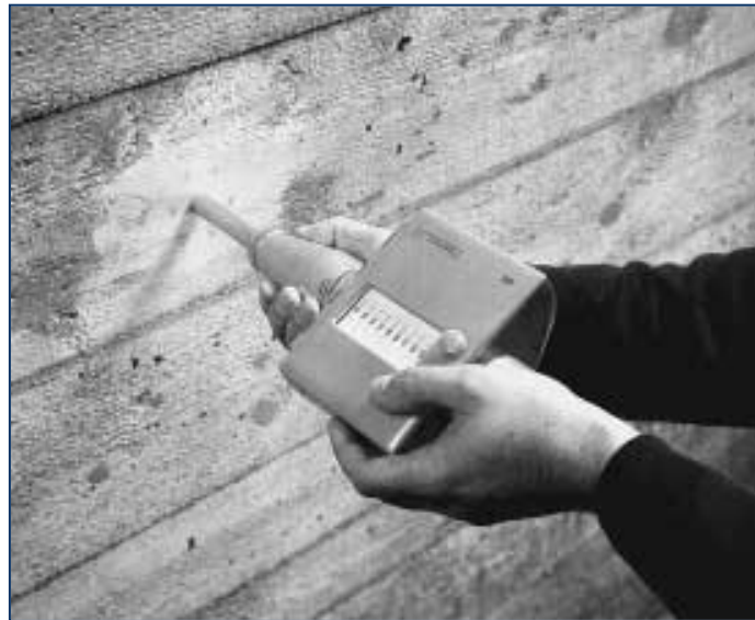
Figure III.5. Mise en œuvre du scléromètre
