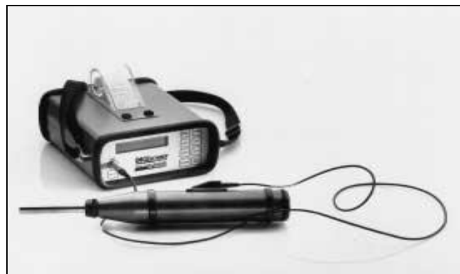
Figure III.4. Modèle Scléromètre avec indicateur et interprétation électronique
