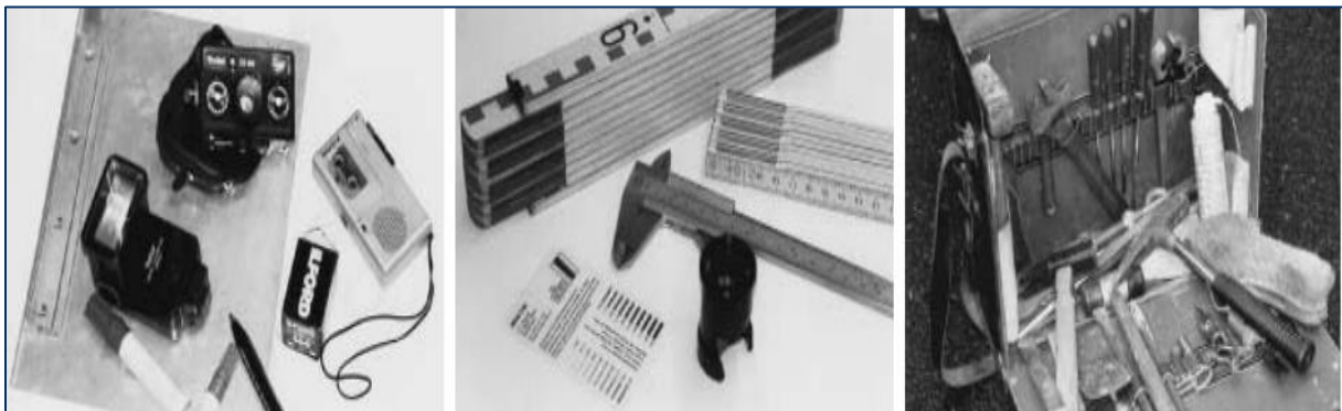
Figure III.2. Exemple d'équipement pour l'auscultation par examen visuel
