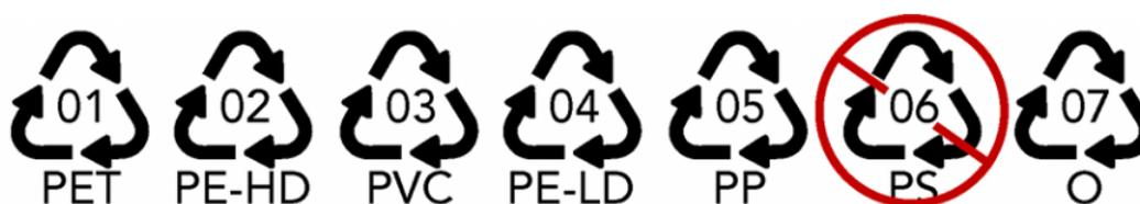
FIGURE 4.5 – Code d'identification des résines thermoplastiques [111]
