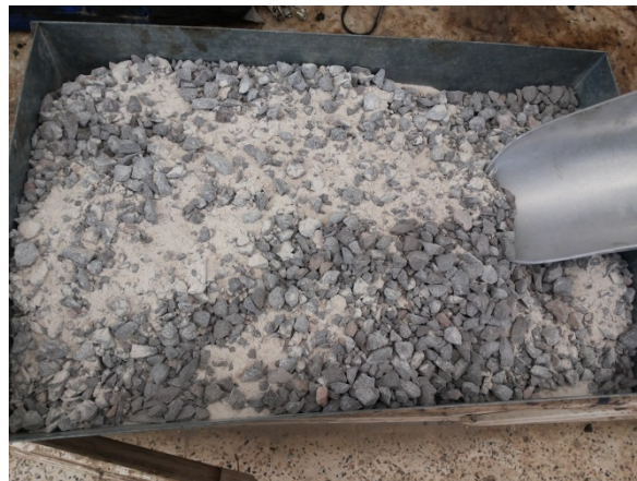
Figure 1.2: Mélange de granulats
