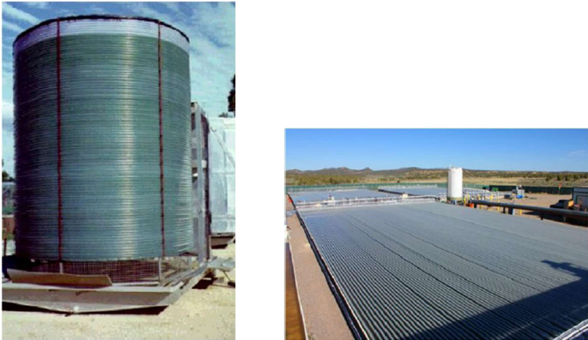
Figure 2.11 Photographies de différentes installations de PBR tubulaires. A gauche : PBR hélicoïdal, vertical Murdoch University, Australie [40]. A droite : PBR tubulaire horizontal immergé dans l'eau, Solix's Lumian™ Algae Growth System.
