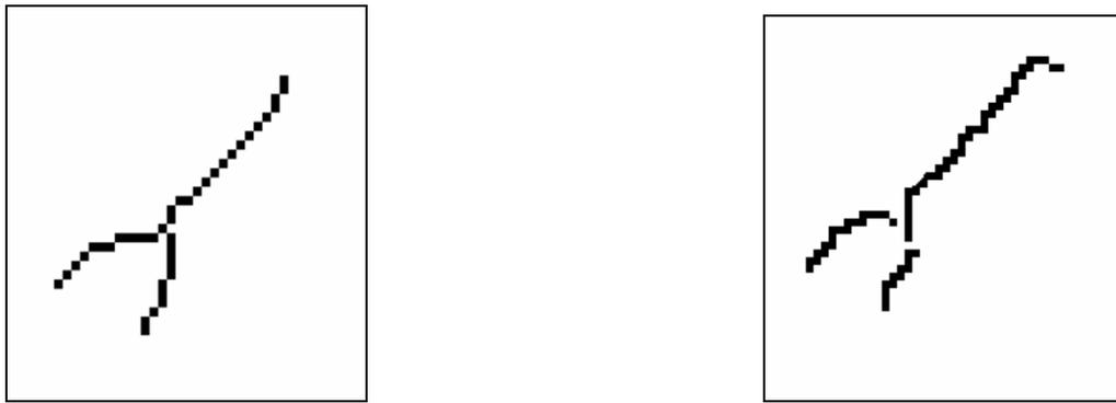
**Figure 4.20 : Résultats de la squelettisation donnée par l'épluchage (à droite) et Zang&Suen (à gauche)**
