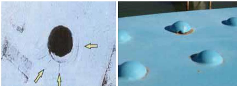
*Fig III.12 Défauts de pose de rivet.*
