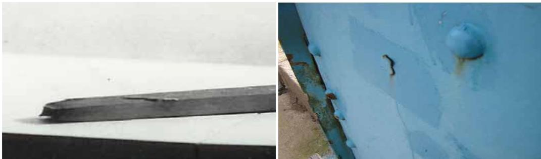
*FIG I.7.Pailles sur éprouvette d'essai et sur ouvrage*
