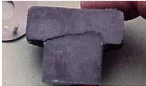
*Fig III.8. Coupe d'un boulon HR galvanisé rompu par fragilisation par l'hydrogène.*
