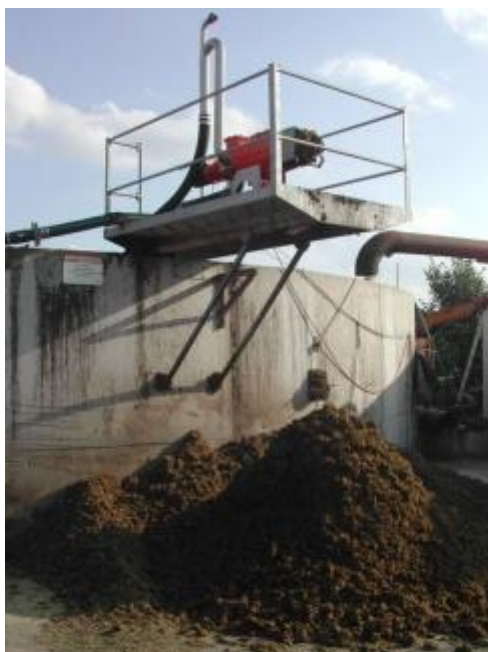
Figure 14 : Élimination des digestats par centrifuge [30]
