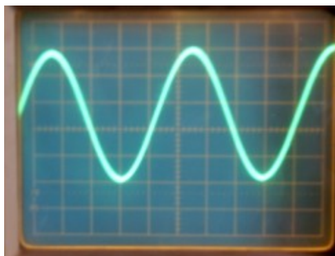
Figure 4.32. Signal de la tension de sortie du bloc émetteur (5V, 1Khz) vers le bobinage
