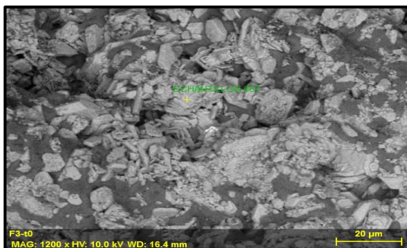
Figure II.2. 6: Micrographie MEB du dépôt solide - Zone 5-
