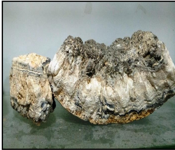
Figure I.1. 4: Dépôt de sulfate de baryum « BaSO 4 »
