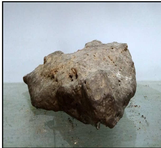
Figure I.1. 3: Dépôt de sulfate de strontium « \text{SrSO}_4 »
