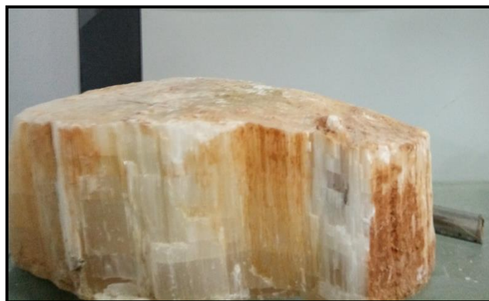
Figure I.1. 2: Dépôt de sulfate de calcium « CaSO 4 »
