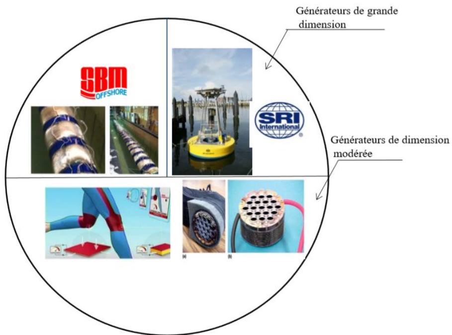
Figure 1.8 : Générateur d'énergie à base des polymères électrostrictifs [5].
