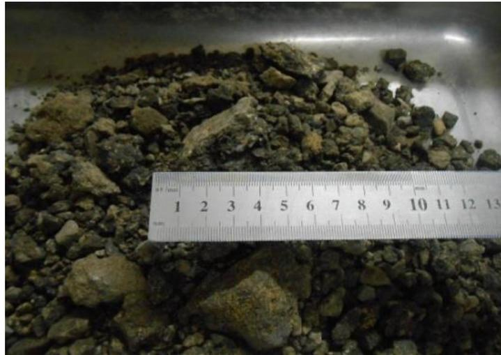
Fig. 2.2 Agrégats de fraisât avant criblage.
