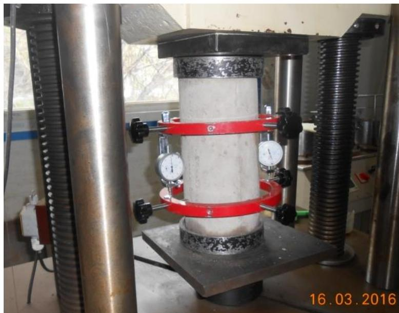
Fig.4.9 Essai de module d'élasticité statique.
