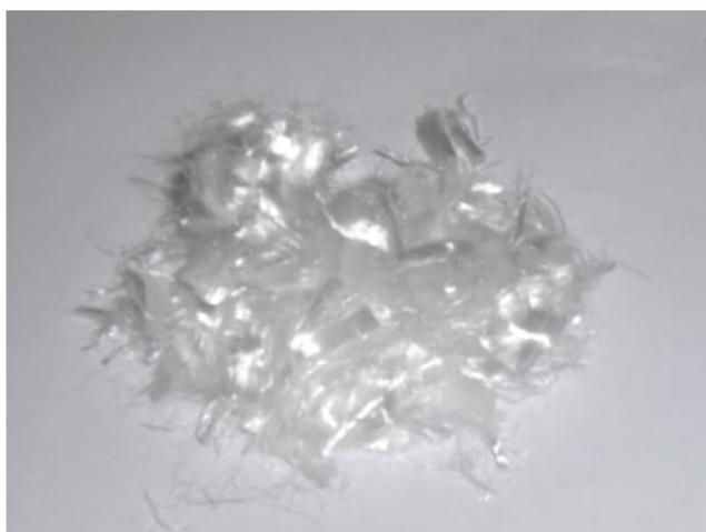
Fig. 2.4 Fibres de polypropylène utilisées.
