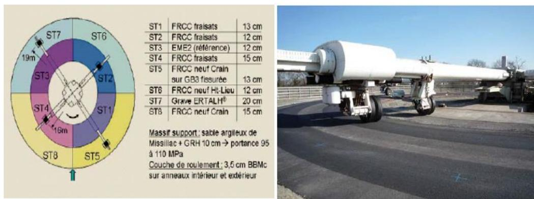
Fig. 1.3 Schéma des 8 structures testées sur le manège de fatigue LCPC (Revue Route, 2010).
