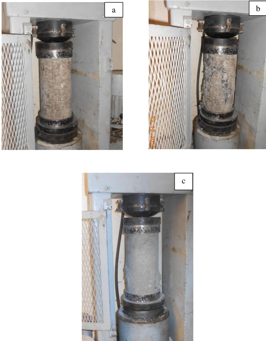
Fig. 3.4 Essai de compression a) Début de l'essai b) Fin de l'essai sur spécimen sans fraisât
