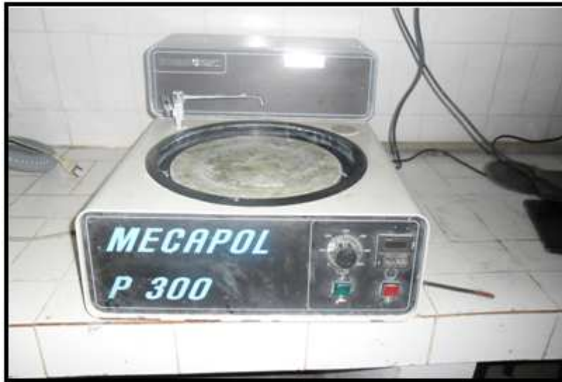
Figure II.8 : photographie réelle de la polisseuse de finition.
