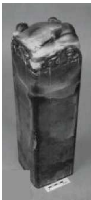
Figure 1.29: Lingot obtenu par coulée continue de silicium [38].
