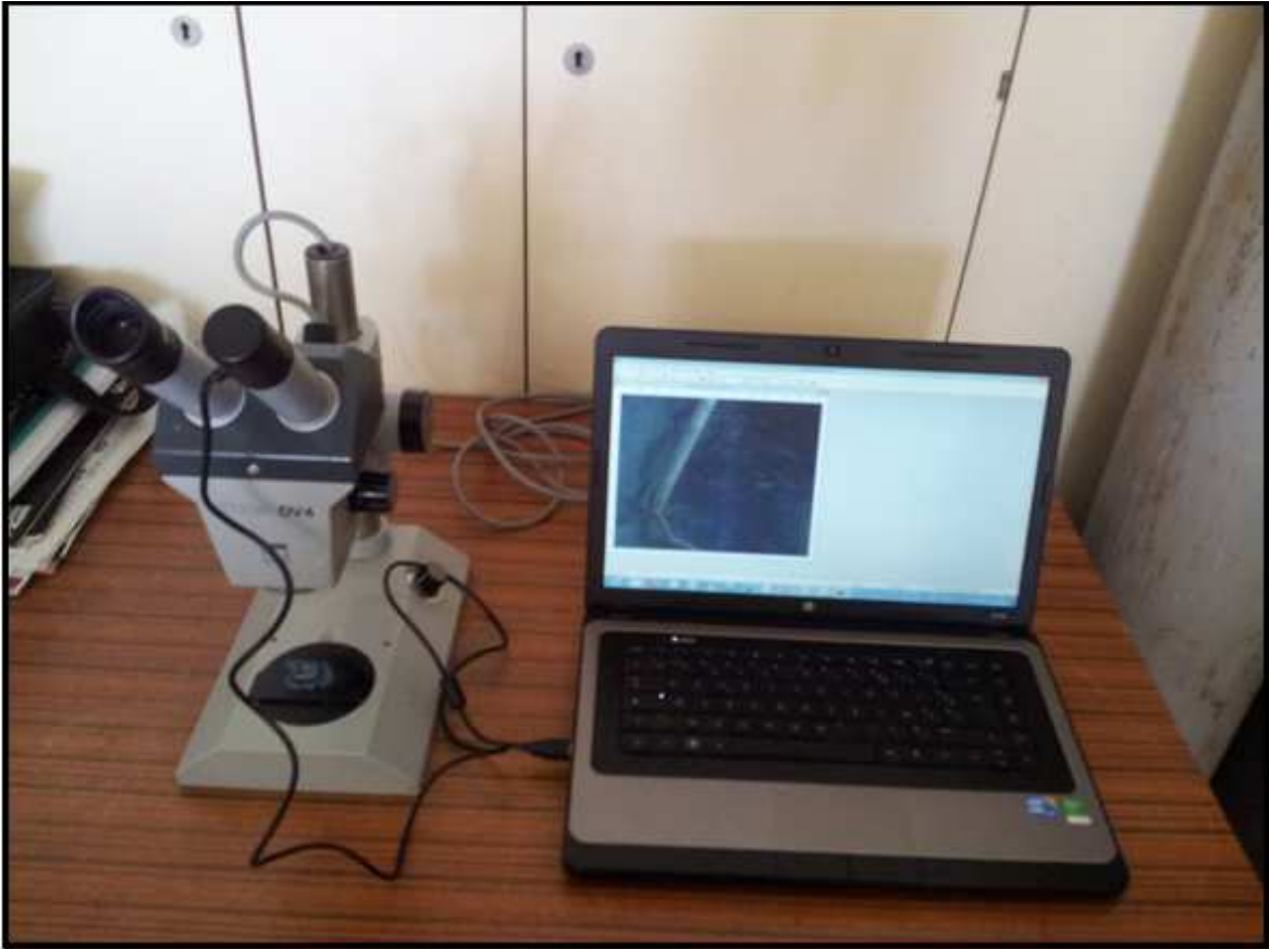
Figure II.18: Photographie réelle de microscope binoculaire.
