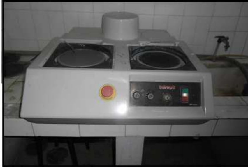
Figure II.7 : photographie réelle de la polisseuse utilisée.
