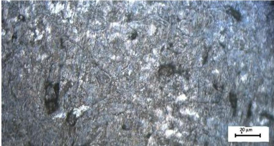
**Figure V.8 :** fonte avec une variation de 0,6%Si, après attaque au Nital 5%.
