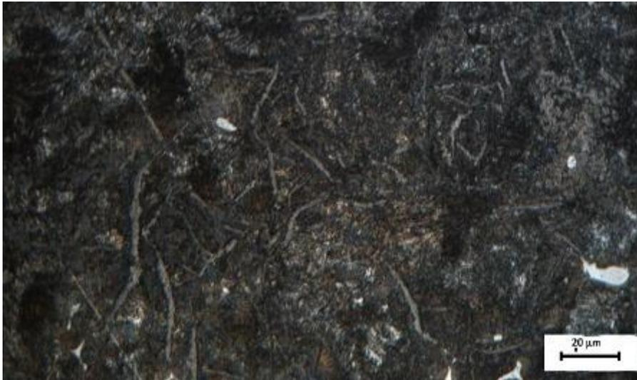
**Figure V.10** : fonte avec une variation de 0,6% Cu, après attaque au Nital 5%.
