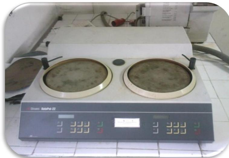
**Figure IV.5 :** Polisseuse à deux plateaux.
