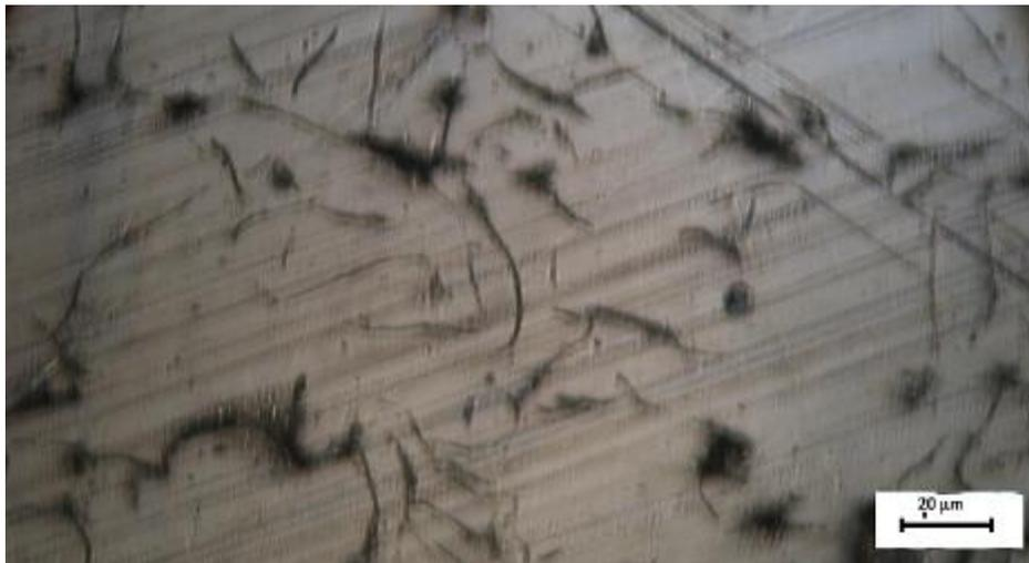
**Figure V.1:** fonte de base sans attaque chimique.
