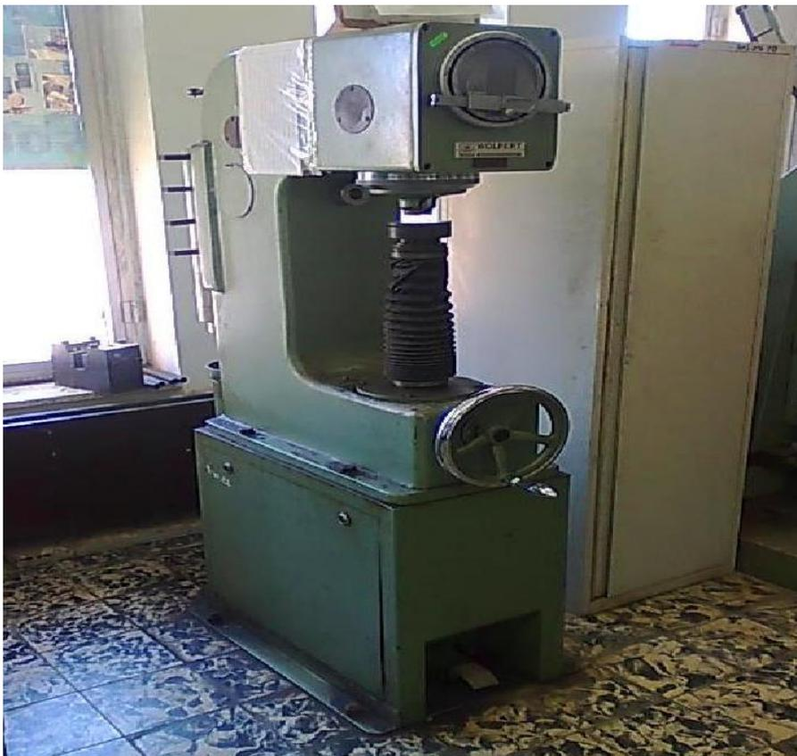
**Figure IV.11:** La machine de dureté HB.
