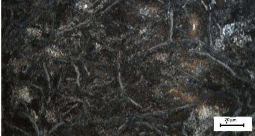
**Figure V.7 :** fonte avec une variation de 0,6% C, après attaque au Nital 5%.
