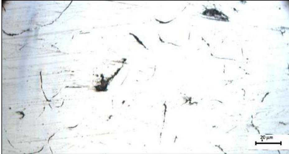
**Figure V.5 :** la fonte avec une variation de 0,6%Mn, sans attaque chimique.
