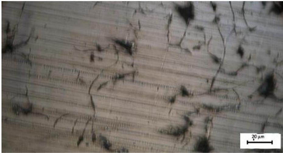
**Figure V.4 :** la fonte avec une variation de 0,6%Si, sans attaque chimique.
