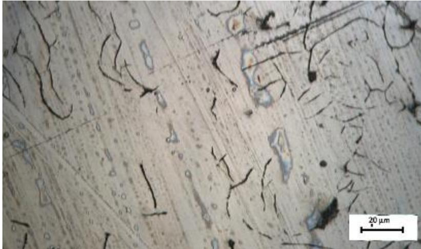
**Figure V.6 :** fonte avec une variation de 0,6%Cu, sans attaque chimique.
