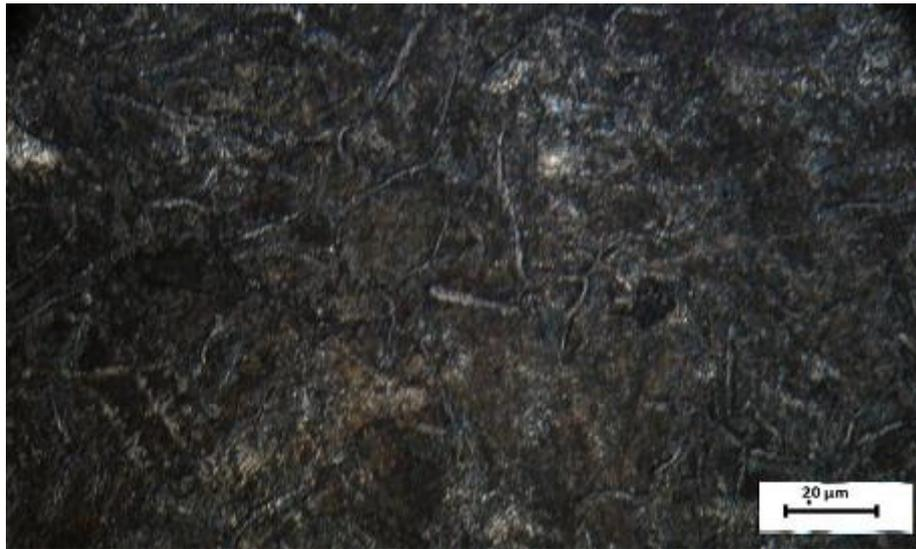
**Figure V.2:** fonte de base avec l'attaque chimique au Nital 5%.
