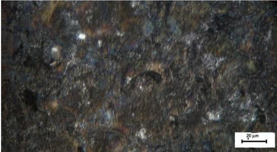
**Figure V.9 :** fonte avec une variation de 0,6%Mn, après attaque au Nital 5%.
