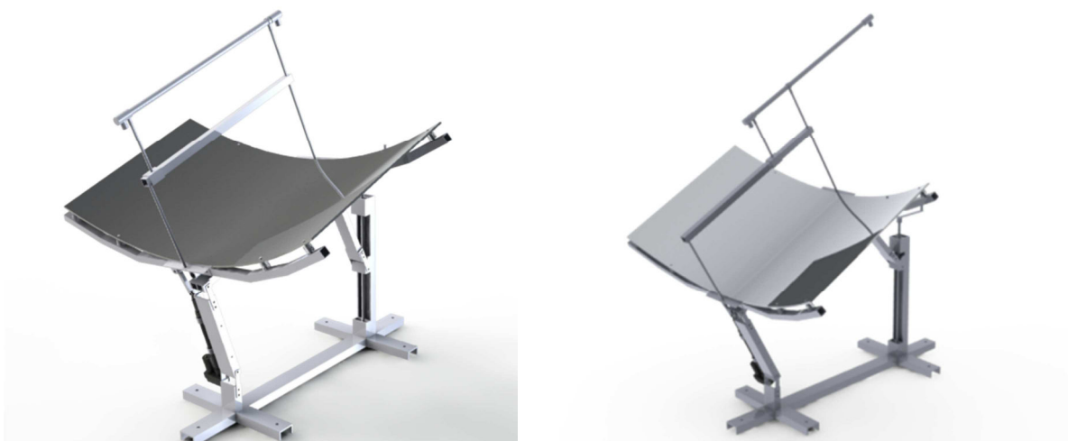
Fig.3.5. Déplacement manuel de l'absorbeur.
