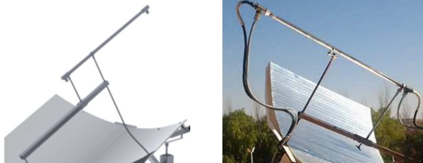
Fig.3.24. L'absorbeur du prototype du concentrateur cylindro-parabolique réalisé.
