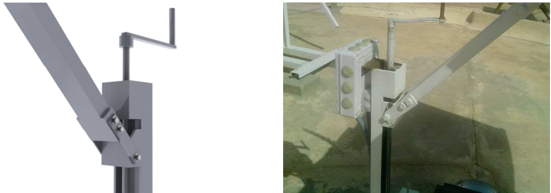
Fig.3.16. Manivelle de variation d'inclinaison du réflecteur.
