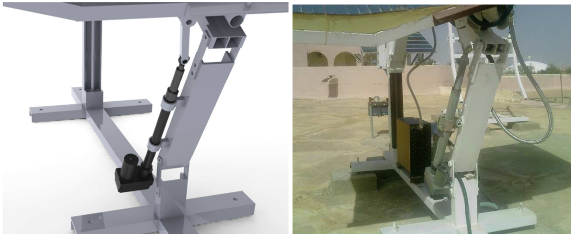
Fig.3.26. Vue du système mécanique de poursuite solaire.
