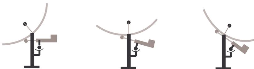
Figure.2.10. Positions du concentrateur en fonction de l'état du vérin.
