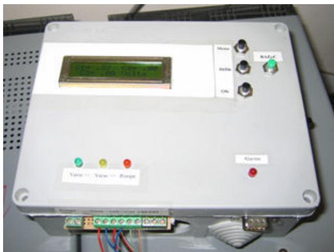
*Figure.3.20. Carte de commande réalisée pour poursuite solaire sensible.*
