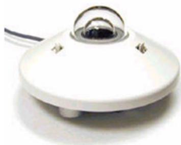
Figure.4.3. Vue du pyranomètre utilisé.
