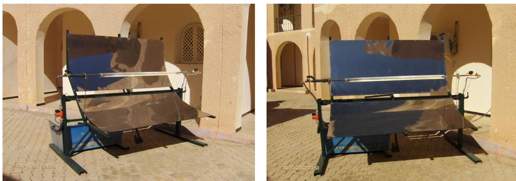
Figure.2.9. Vue du concentrateur réalisé.
