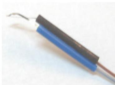
Figure.4.2. Le thermocouple Type K utilisé.
