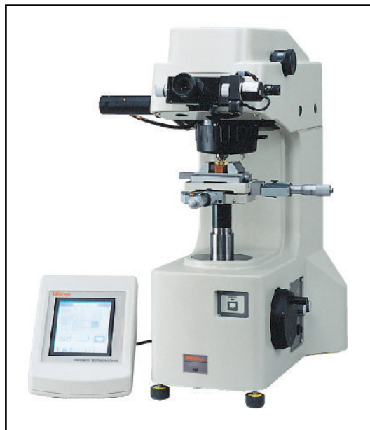
Figure III.11 : Machine de microdureté utilisée dans notre étude.
