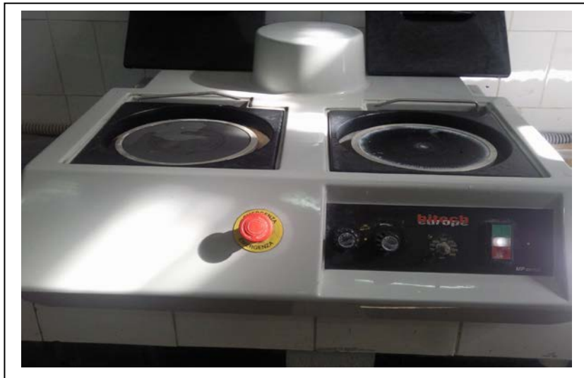
Figure III.5 : Polisseuse mécanique utilisée.
