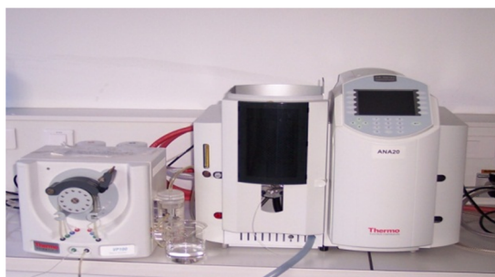
Figure V.8. Dispositif de l'analyse chimique à absorption atomique
