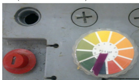
Figure VI.9. Essai de pH-mètre pour mesurer la concentration de l'électrolyte de la batterie
