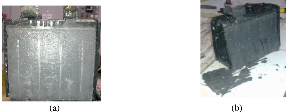
Figure IV.10. Éléments des batteries, (a) batterie n°01, (b) batterie usée
