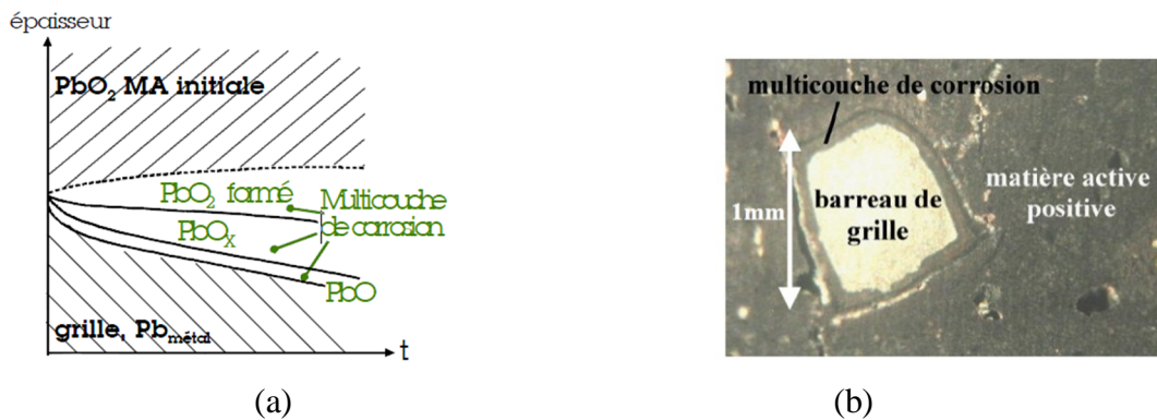
Figure III.14: a. évolution schématique sur plusieurs mois de la multicouche de corrosion à l'électrode positive b. vue au microscope optique d'une grille positive sectionnée et polie, entourée de sa matière active, d'un élément de batterie rechargé 2 mois à 13,5V après 5 mois d'autodécharge
