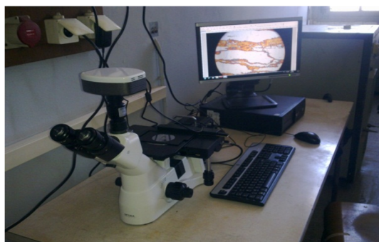
Figure V.6. Microscope optique OLYMPUS avec acquisition d'image
