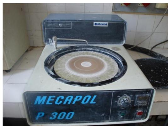
**Figure IV.6.** polisseuse utilisée pour le polissage de finition.
