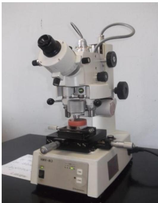
**Figure IV.9.** Microduromètre utilisé.
