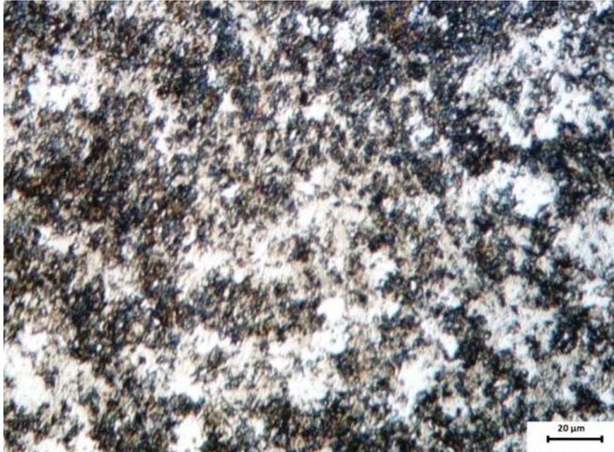
**Figure V.9.** Micrographie de l'acier XC80 austénitisé à 760 °C pendant 360 s (A4).
