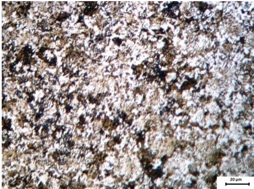
**Figure V.8.** Micrographie de l'acier XC80 austénitisé à 750 °C pendant 360 s (A3).
