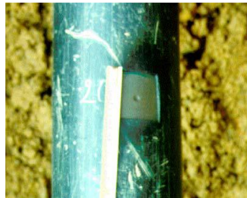
Figures I.8 : a) Oxyde ( 40 \times 40 \text{ mm} ) et produit de corrosion, b) Corrosion ( \text{diam } 5 \text{ mm} ; \text{prof. } 0,5 \text{ mm} ) [1]
