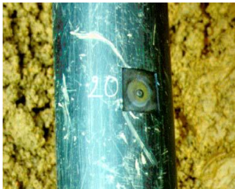
Figures I.8 : a) Oxyde ( 40 \times 40 \text{ mm} ) et produit de corrosion, b) Corrosion ( \text{diam } 5 \text{ mm} ; \text{prof. } 0,5 \text{ mm} ) [1]
