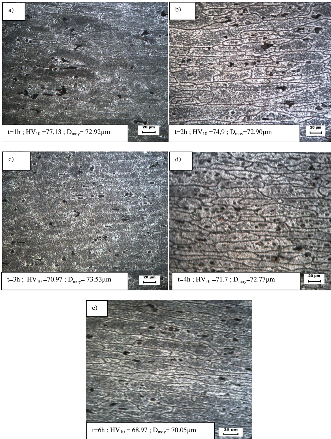
Figure V.7 Evolution de la microstructure de l'alliage 2024 T3 laminé à 40 % et recuit à 256°C pendant : a) 1h ; b) 2h ; c) 3h ; d) 4h et e) 6h (Gx 500)
