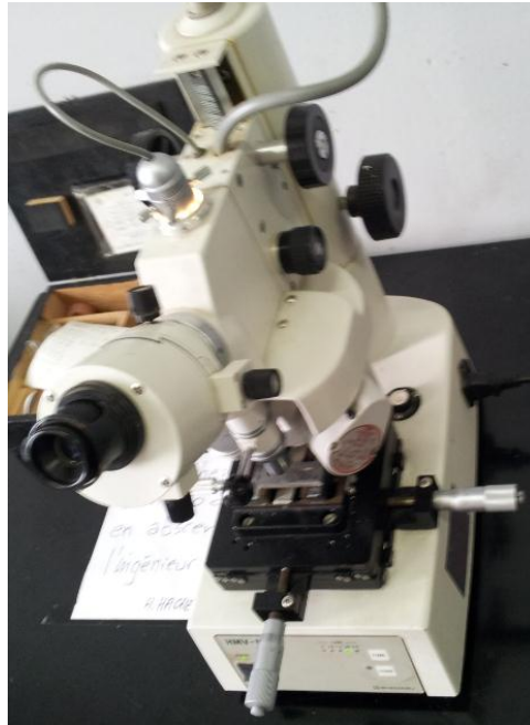
Figure III.7 : Micro-duromètre de type « SHIMADZU HMV-M3 ».
