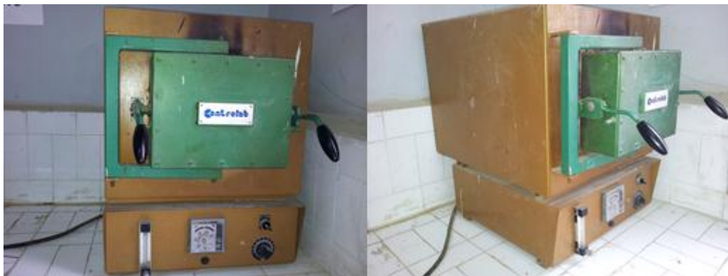
Figure III.2 : Four à résistance électrique, de 1200°C
