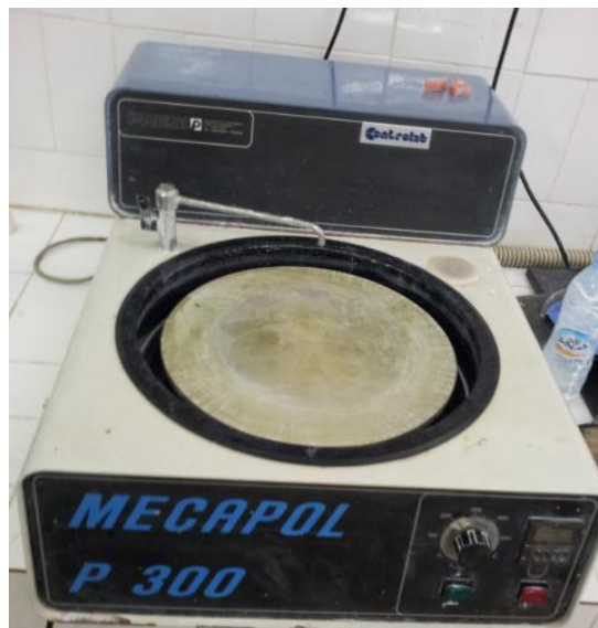
Figure III.6 : Polisseuse de finition utilisée de type « MECAPOL P300 ».
