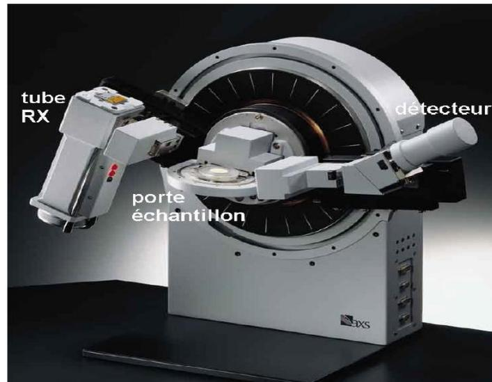
**Figure III. 11:** Diffractomètre des rayons X [29].
