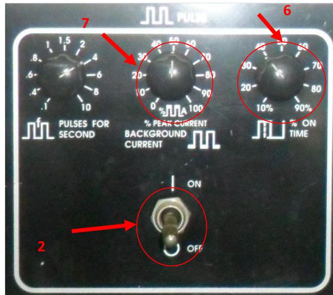
**Figure IV-A. 4:** réglage du courant pulsé.
