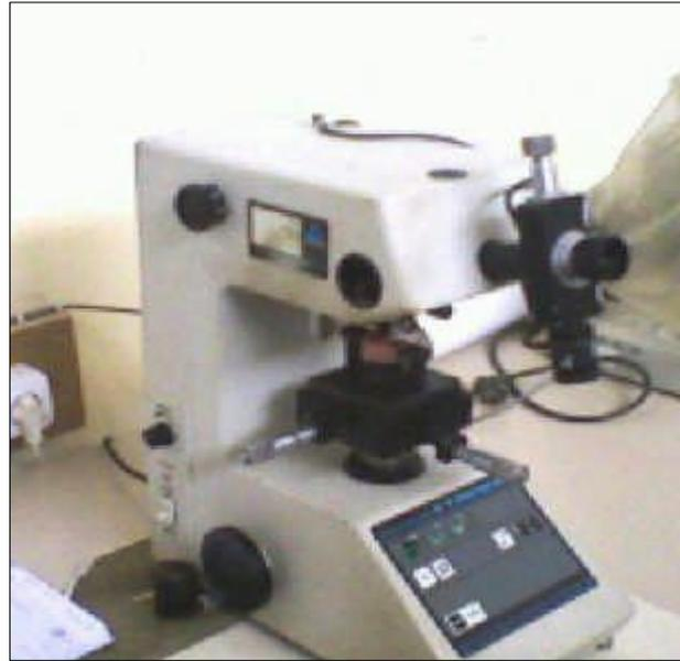
**Figure III. 13:** micro-duromètre.
