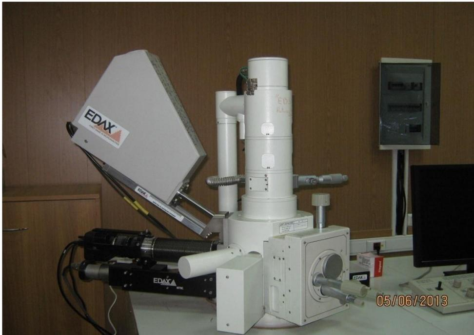
**Figure III. 10:** microscope électronique à balayage.
