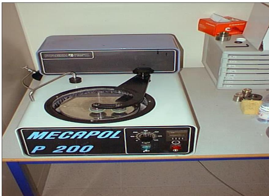
**Figure III. 6:** la polisseuse utilisée de type« MECAPOL P200 ».
