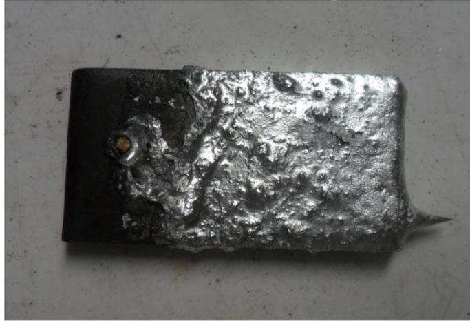
**Figure IV. 15.** Profil de la pièce galvanisée d'alliage de Zn-6%Al à l'état initial.
