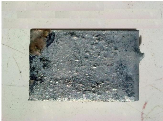
**Figure IV. 16.** Profil de la pièce galvanisée d'alliage de Zn exposé pendant 7 jours.
