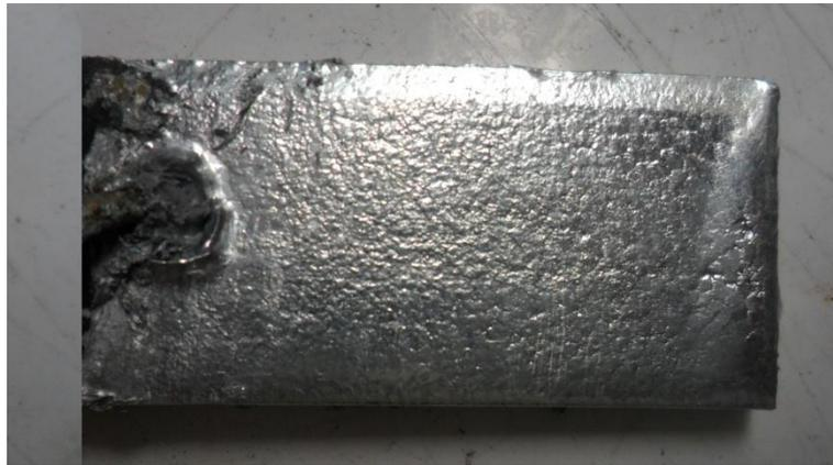
Figure III. 2. Éprouvette galvanisée.
