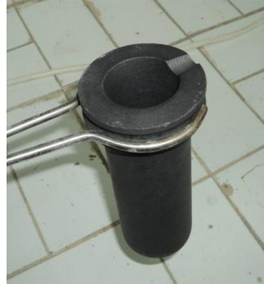
**Figure III. 4.** Four de galvanisation      **Figure III. 5.** Creuset de four de galvanisation
