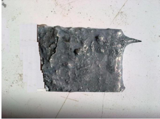
**Figure IV. 17.** Profil de la pièce galvanisée d'alliage de Zn-6%Al exposé pendant 7 jours.
