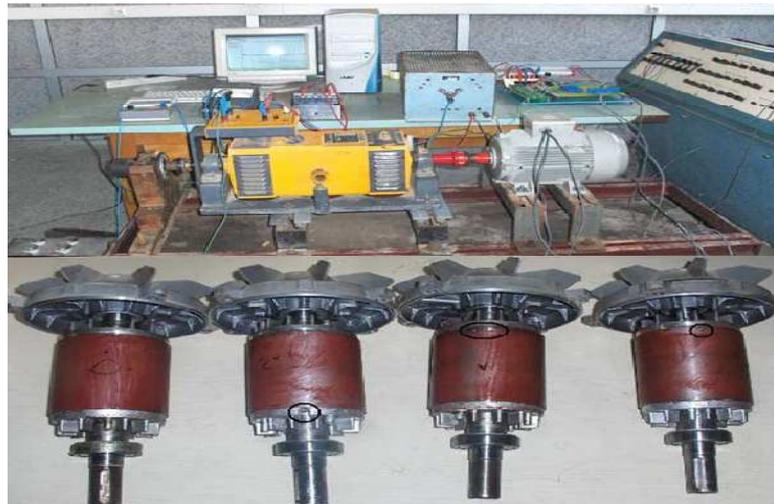
**Figure (B-1):** Banc d'essai et les quatre rotors.
