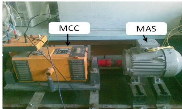
**Figure (II.5):** La machine asynchrone et la charge.
