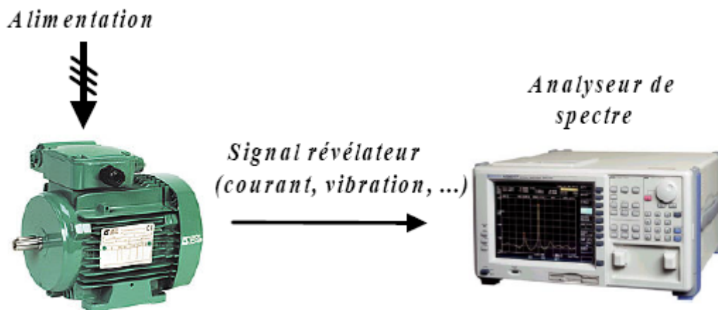
Fig I.6 Principe de la surveillance par analyse spectrale
