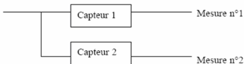
Figure I.2 : Schéma représentant la redondance matérielle.
