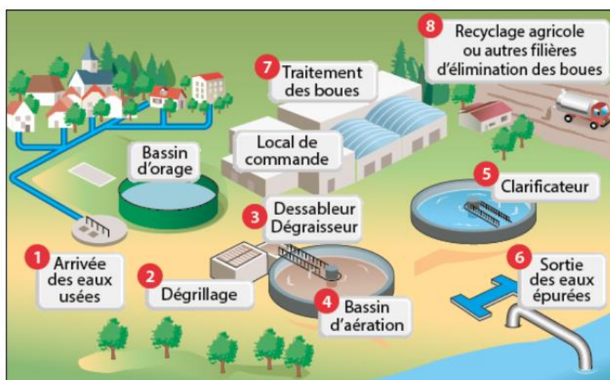
Figure 1.1 Principe de fonctionnement d'une station d'épuration. [1]
