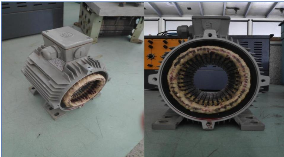
**Figure 5.1 9 : Stator de la machine réalisée.**
